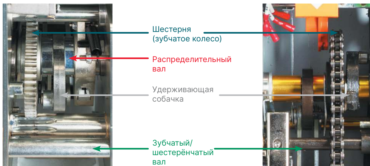
РИСУНОК 7. МЕХАНИЗМ ПЕРЕДАЧИ
