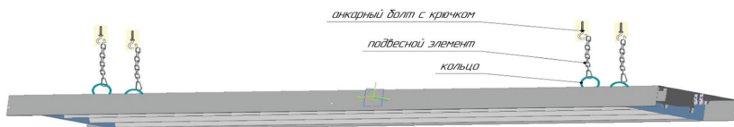
Рисунок 4. Схема подвеса электрообогревателя.
